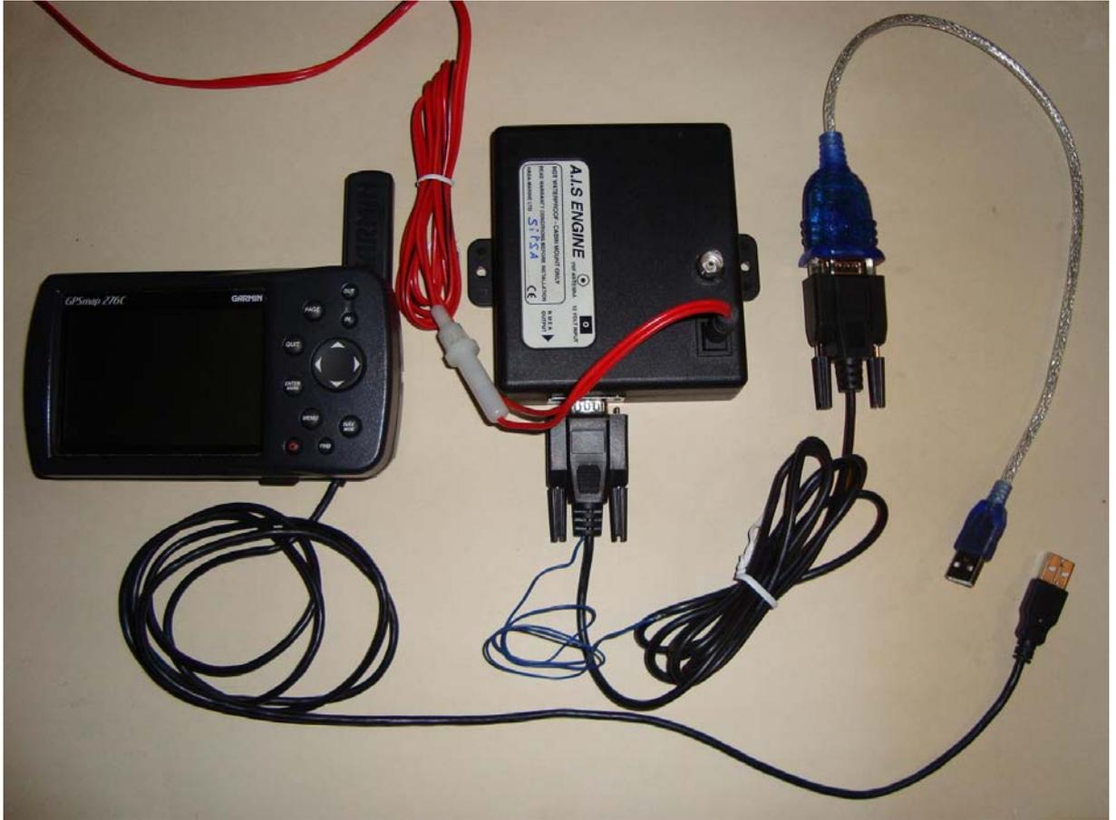
**En este caso no conectamos el cable azul del AIS, sencillamente conectamos el AIS a través de su respectivo cable al ordenador y el GPS con el propio cable que en este caso es USB.**
