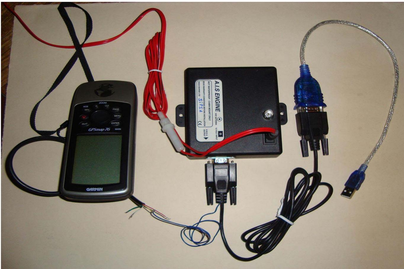
En este caso debemos conectar la salida de datos del GPS (Data out) al cable azul que dispone el AIS y el cable Negro del GPS, (el negativo) debe estar conectado
